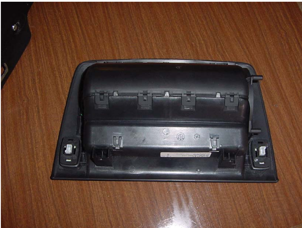
Seguidamente con una cartulina nos hacemos una plantilla de la forma que tendrá el agujero en el tablier de la parte inferior de la carcasa
